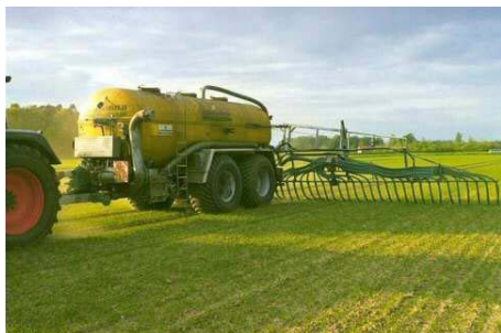
Foto carrobotte in vetroresina Zunhammer con distribuzione a tubi striscianti
